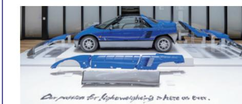
1992年に発売されたAutozam AZ-1は、FRP(繊維強化プラスチック)製ボディパネルを採用した革新的な超小型スポーツカーで、当社も内外装樹脂部品開発に参画していました。本社落成にあたり、当社の軽量化へのチャレンジの「原点」とも言えるこの車と当社が開発に携わった部品を本社1階に展示しています。軽量化に対する情熱を絶やさず、当社の軸として引き継いでいくという強い意志と熱い想いが込められています。
