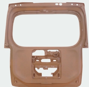
ポリプロピレンにCNFを30% 添加したテールゲート・インナーパネル
